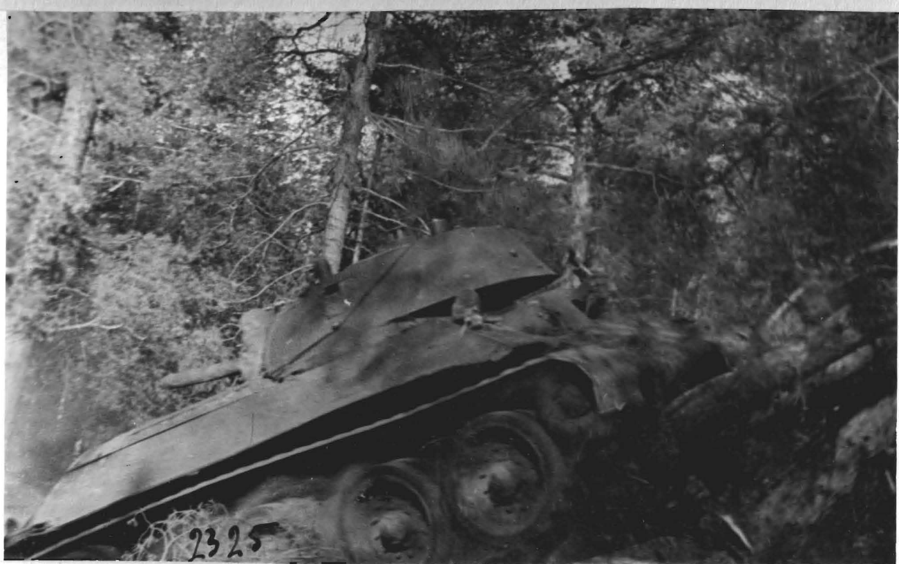
Танк преодолевает группу сосен T_{\text{шт}} \phi 300-446 \text{ мм} .
