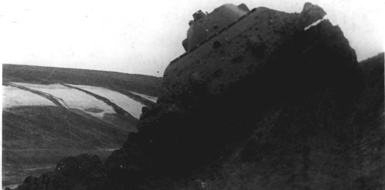
Танк преодолевает косогор Крутизной 32^{\circ} на I ой передаче.
